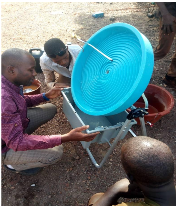
Montage du concentrateur à spirales par les artisans locaux
